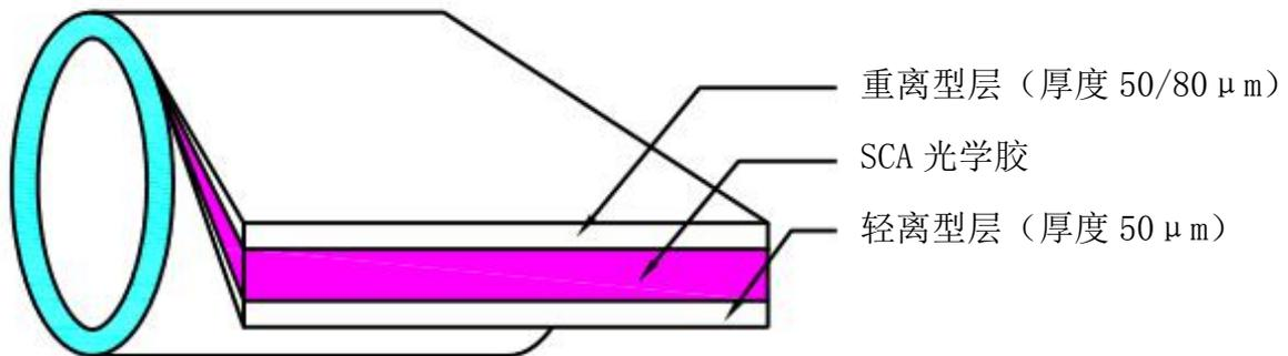
注：离型层材质上层 PE（软），下层 PET（硬）
